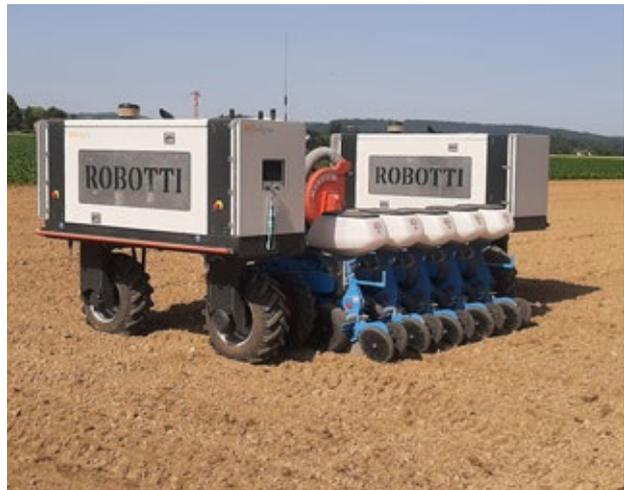
»Robotti« ist GPS-gesteuert und fährt, ausgestattet mit verschiedenen Arbeitsgeräten, autonom über das Feld.
